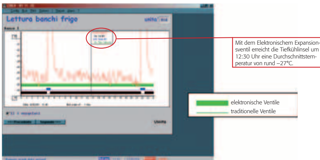
Abb. 15: Vergrößerung auf TAGESBASIS der Betriebstemperatur der Tiefkühlinsel Nr. 11 mit ELEKTRONISCHEM VENTIL
