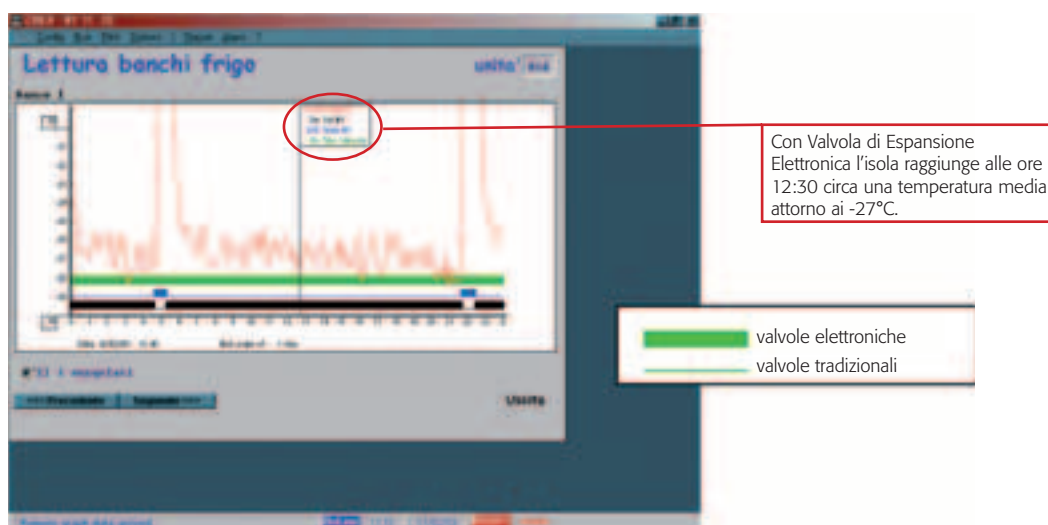
Fig. 15: Ingrandimento su scala GIORNALIERA della temperatura di lavoro dell'isola surgelati n°11 funzionante con VALVOLA ELETTRONICA
