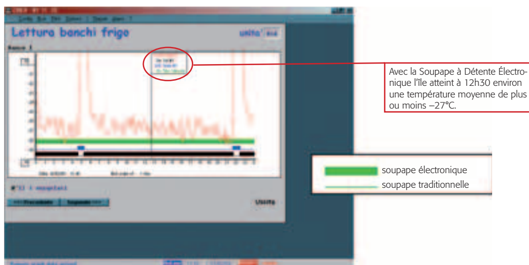
Fig. 15: Agrandissement sur échelle QUOTIDIENNE de la température de service de l'île surgelés n°11 fonctionnant avec une SOUPAPE ÉLECTRONIQUE
